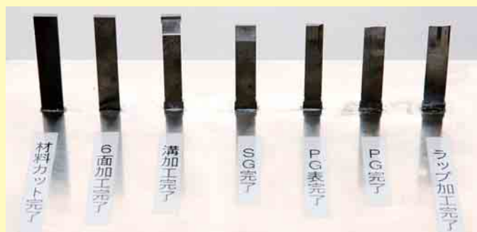
微細な穴を打ち抜くパンチの製造工程モデル
