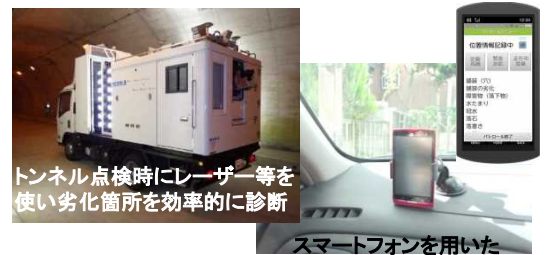
スマートフォンを用いた道路舗装点検の試行
