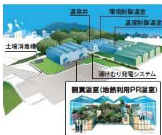
地熱利用型スマート農業ハウス
