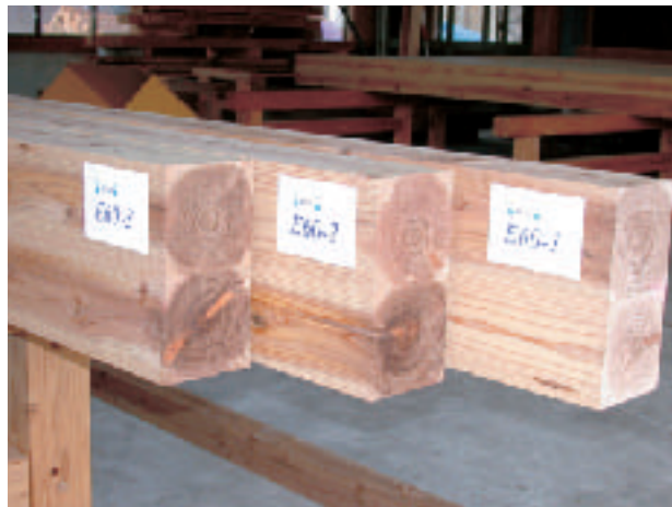
写真1 スギ2段重ね梁60
