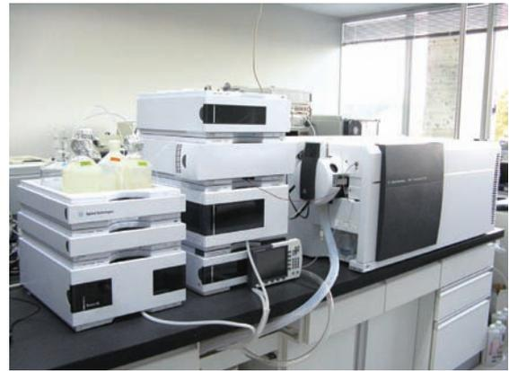
図3 高速液体クロマトグラフ質量分析装置 (LC-MS/MS)
