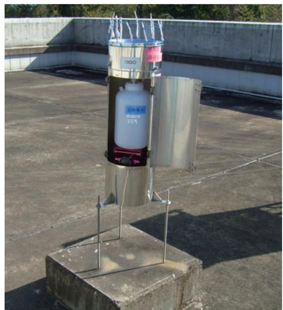
図7 雨水採取装置 (当センター屋上)
