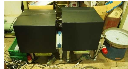
(写真2) メッキ不良ねじ検品システム
