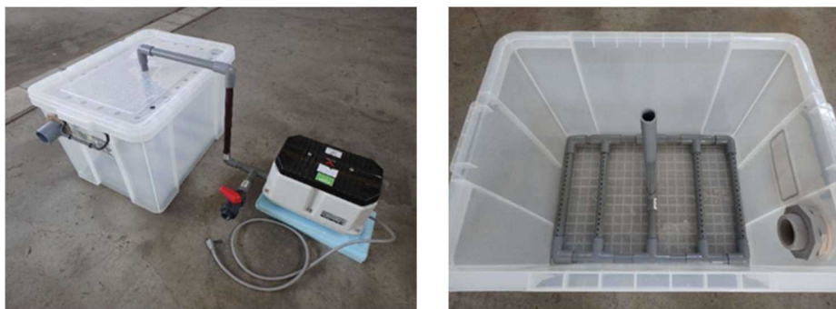
図 4 送気式ばっ気装置(実証試験器)
