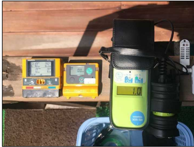
図 24 拡散式及び吸引式硫化水素計
