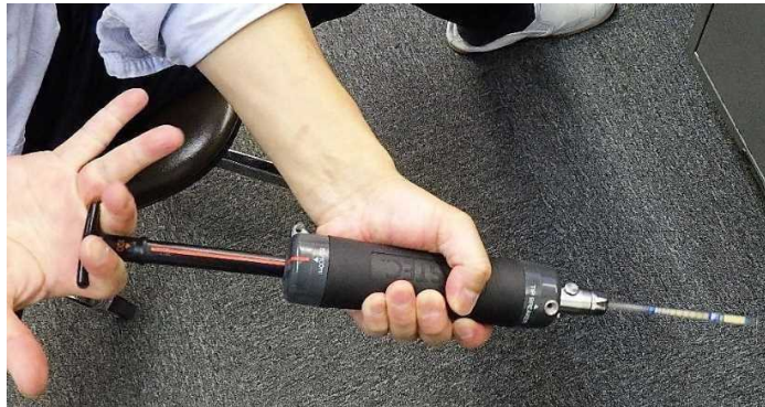
図 20 ストップを解除しハンドルを引きながら戻す状況
