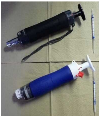
図 10 検知管法ガス採取器
