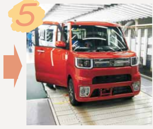
検査工程 出来上がった自動車は、ブレーキやハンドル、雨漏れ、傷など一台一台検査され、出荷ヤードに運ばれます。
