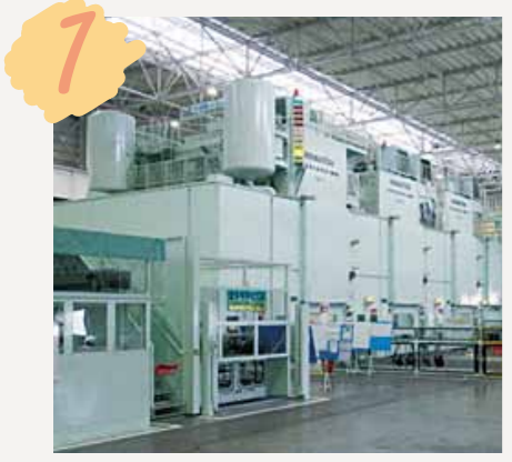
プレス工程 ロール状の鉄板を切断し、大型のプレス機で自動車のボデーを構成するドアやボンネットなどに成形します。
