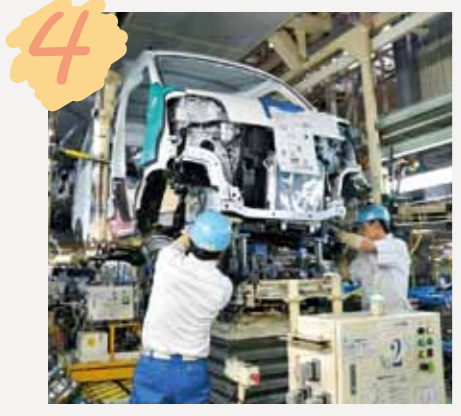
組立工程 塗装された車体に、エンジン、ステアリング、マフラー、タイヤ、ガラス、シートなどの部品が順序よく取り付けられ、自動車としてつくり上げられます。
