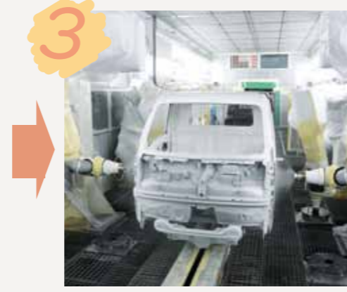
塗装工程 車体についた物などの汚れを落としてから、さび止め液の槽につけられます。その後、ロボットで塗装され、熱風を発生させるトンネルの中で焼きつけられます。
