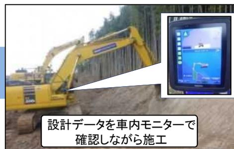
設計データを車内モニターで確認しながら施工
