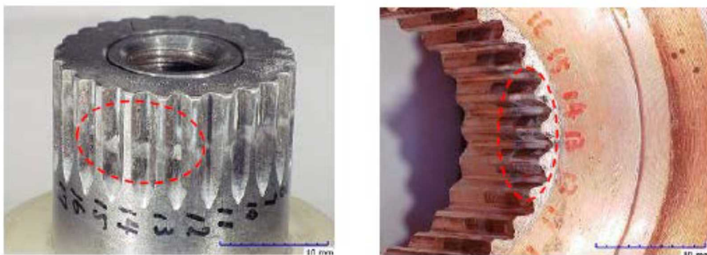
図8 放電試験後 解体品の確認結果
