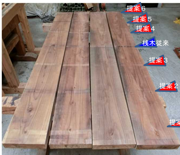
写真1. 乾燥終了後の表面の状況 (▲ 栈木の位置) (左2枚: 従来の乾燥方法、右2枚: 図1の乾燥方法)
