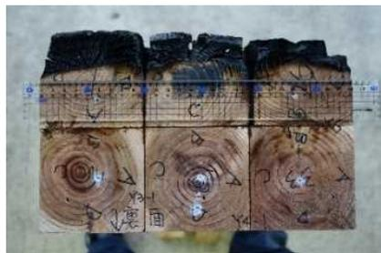
1時間燃焼試験後の試験体
