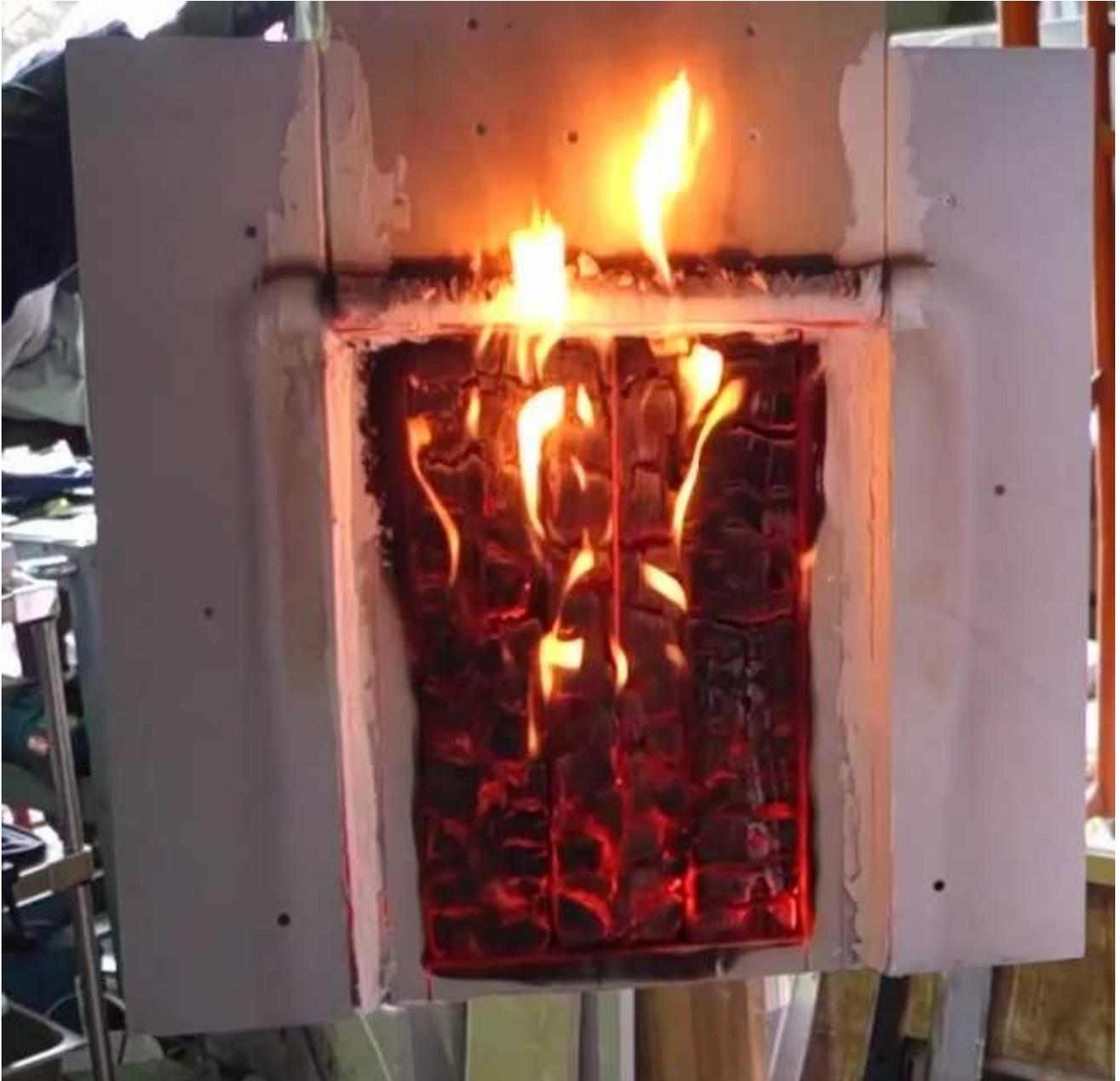
合わせ柱試験材の1時間燃焼試験時の様子(一般流通製材を用いた大断面柱材の開発)
