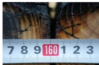
1時間燃焼試験後の合わせ柱の合わせ目
