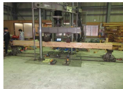
スギ大径材を利用した重ね梁の強度試験
