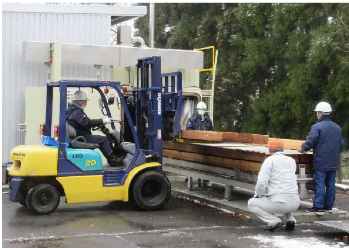
新たに導入された多機能木材乾燥機(高周波減圧乾燥試験の様子)
