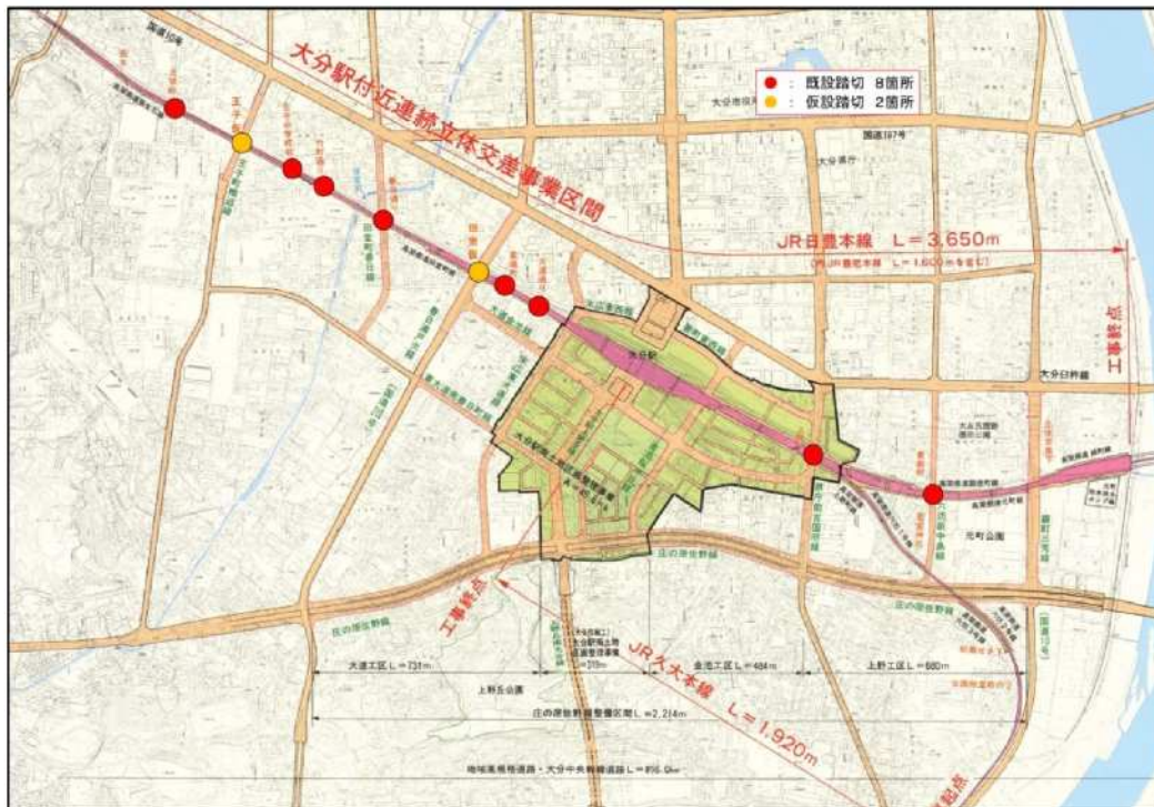
【JR日豊本線高架切替により、撤去される踏切(10箇所)】
