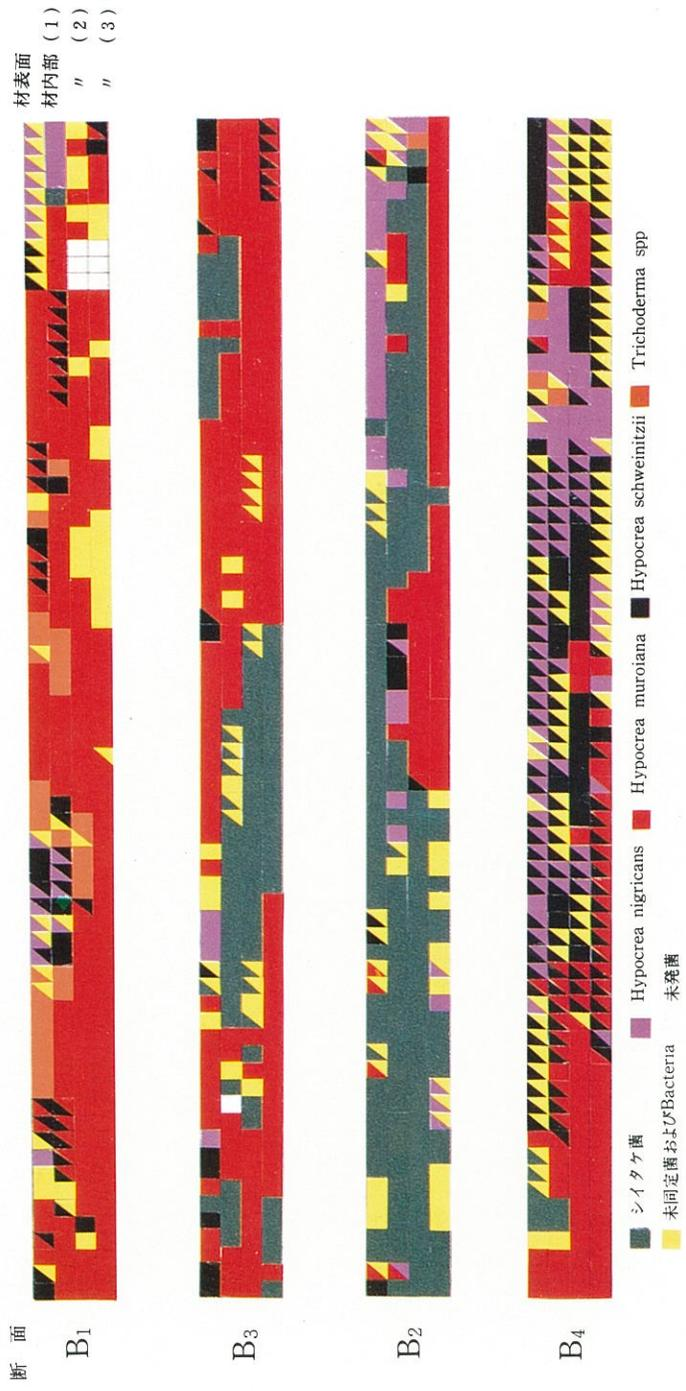
図69. 黒腐病被害木における各断面の深さ別検出菌の分布状態 (S.53年度)
