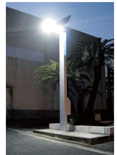
地場企業の開発によるLED、無電極ランプ、太陽光パネルを組み合わせた省エネタイプの街路灯
