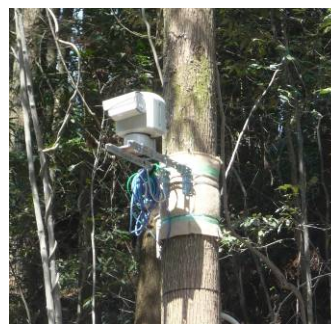
【監視観測機器の整備状況(新燃岳噴火時の緊急対策 左:監視カメラ、右:ワイヤーセンサ)】 (九州地方整備局宮崎河川国道事務所提供)
