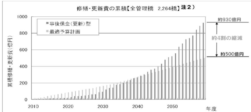
注1) 文献等で一般的に示される既設橋の橋梁寿命（60年～100年）を参考に、管理橋を60～100年の間で段階的に更新した場合の更新費を積み上げたもの
