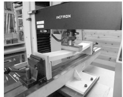
写真-3 曲げ試験
