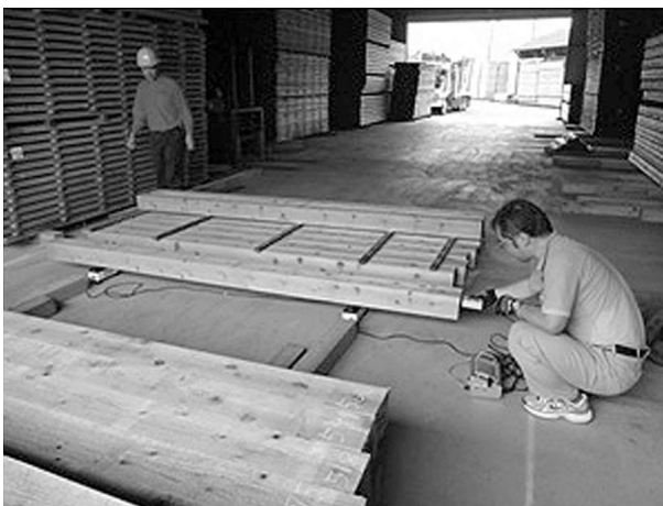
写真-1 県南部でのヤング係数の測定
