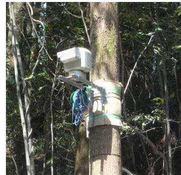
【監視観測機器の整備状況(新燃岳噴火時の緊急対策 左:監視カメラ、右:ワイヤーセンサ)】 (九州地方整備局宮崎河川国道事務所提供)
