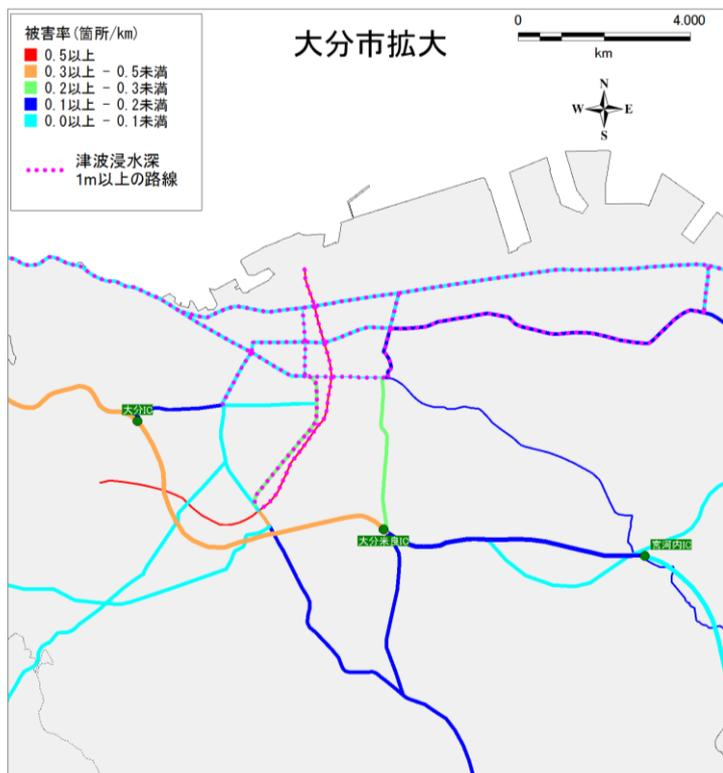
図 8-20 道路被災<周防灘断層群主部による地震> (H25 調査結果)
