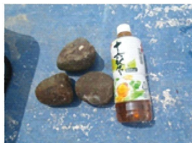
図6 詰まった石の大きさ
