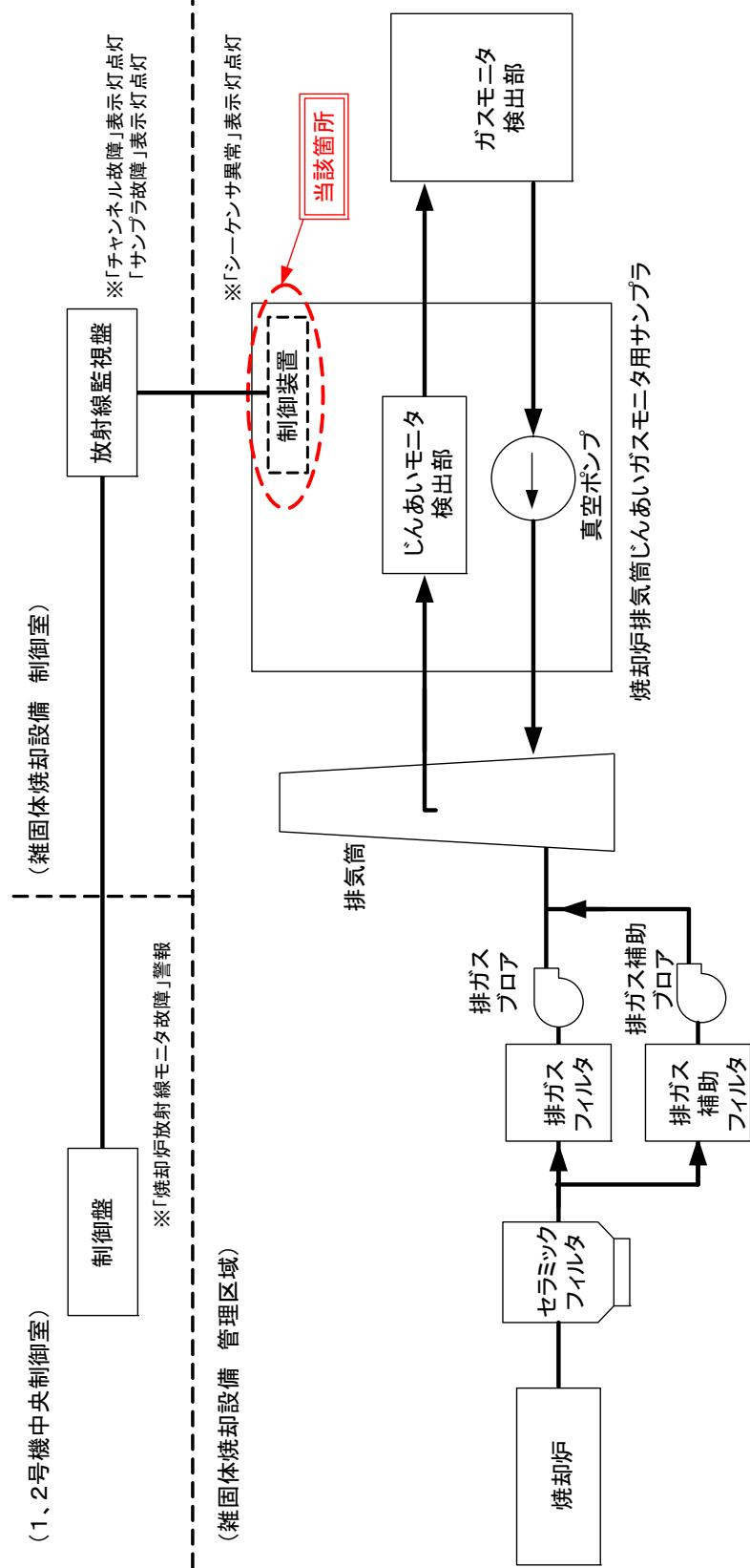
焼却炉排気筒じんあいモニタ制御装置 警報発信状況
