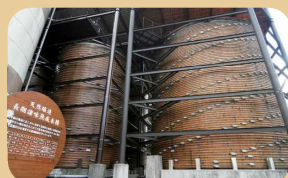
直径、高さともに9mの世界一大きな醤油の木樽(フドーキン醤油)
