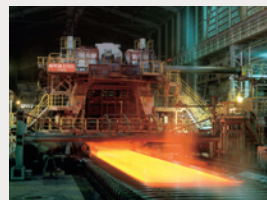
鋼を引きのばす工程
