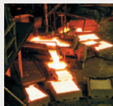
精製炉からアノードをつくる工程
