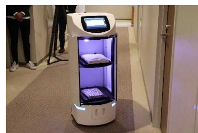
荷台ロック自動開閉で受取
