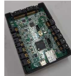
フライトコントローラの試作機 （基盤設計と堅牢性の高い筐体製作）
