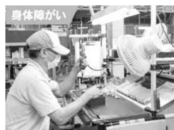
作業台の高さ調整、使用工具の吊
