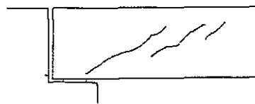
支点部付近の斜め方向ひびわれ
