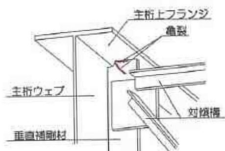
主桁・対傾構取合い部
