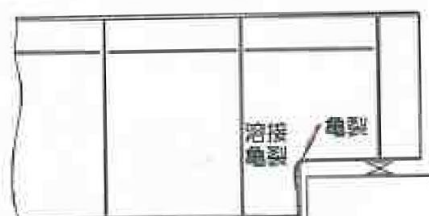
主桁腹板切欠き部
