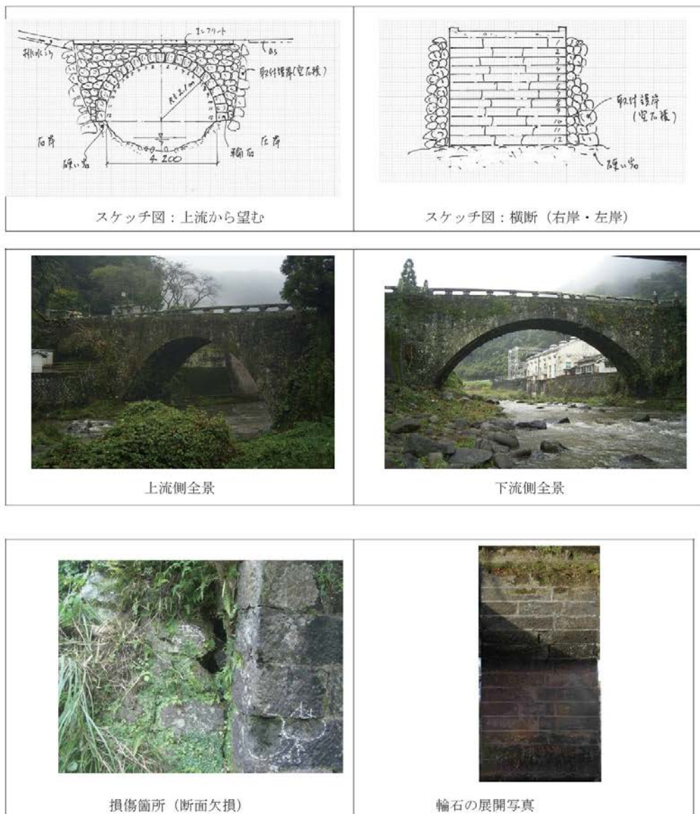
図3.3.2 石橋の損傷スケッチと写真撮影
