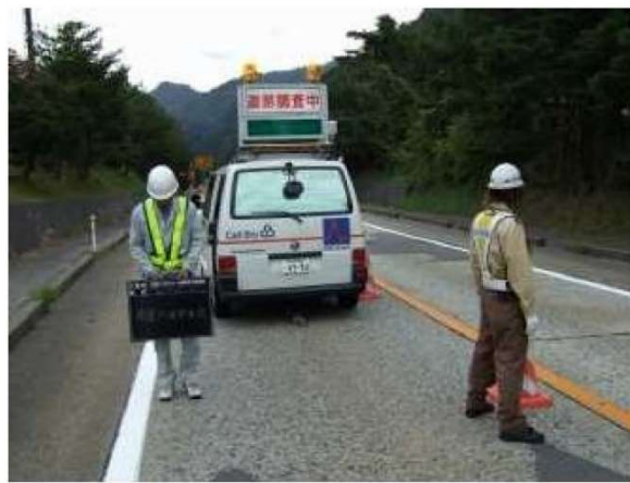
(コンクリート舗装における FWD たわみ量調査)
