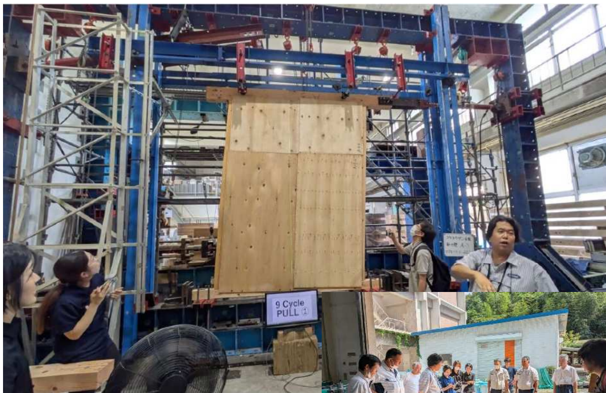
コウヨウザン合板の耐力壁面内せん断試験
