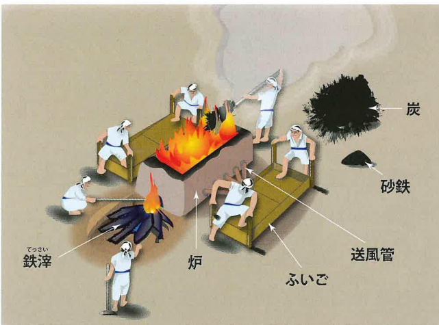
箱形炉を使った作業イメージ図
