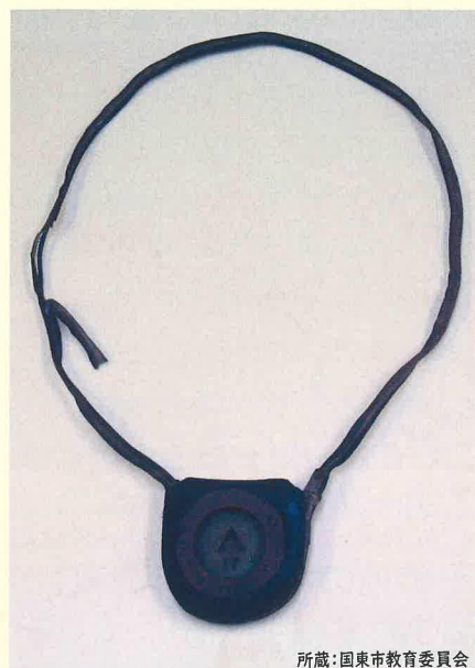
タブレットキャリア 大分交通国東線で使用 (中の通票は、安岐-武蔵間【▲】) 通票(タブレット)を入れた頑丈なケース。肩に掛けて運んだり、乗務員へ受け取りしやすいよう、大きな輪がついている。
