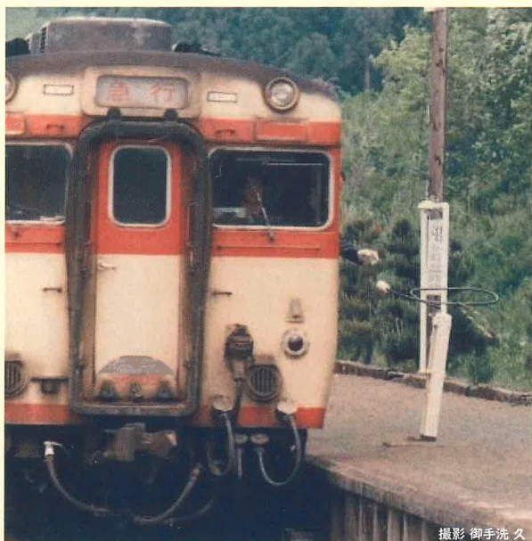
急行火の山からタブレット受け器に通票の投げ入れ 豊肥本線 豊後萩駅 昭和56(1981)年5月
