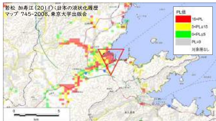
図 1946年『昭和南海地震』における液状化発生場所と本調査『南海トラフの巨大地震』液状化(PL値)分布の比較
