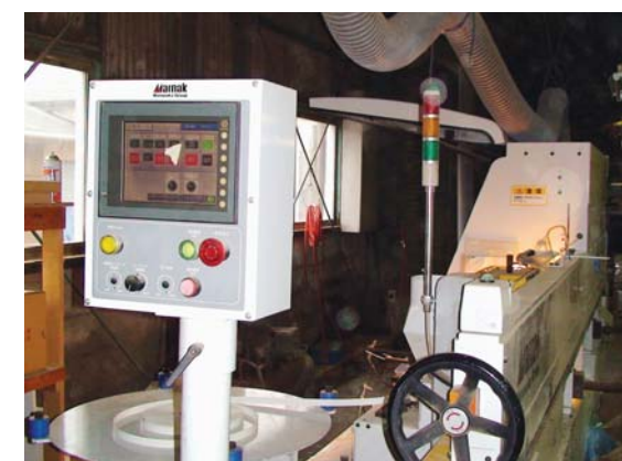
危険な作業が多いので機械にはパトライトが設置されている
