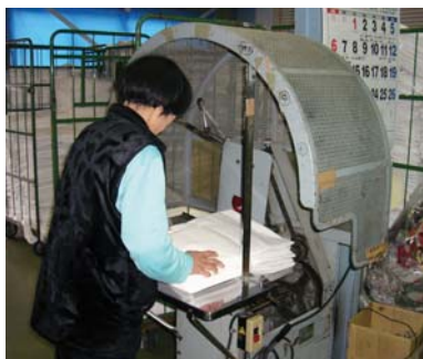
シーツを機械で束ねる作業
