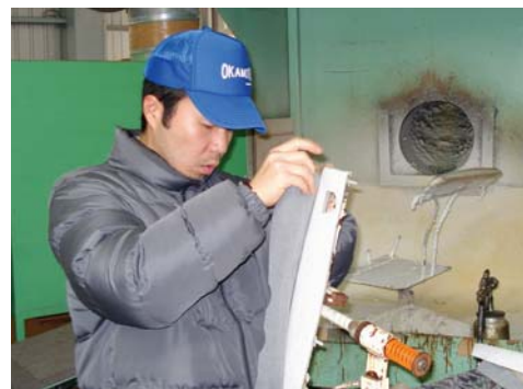
車のひじ掛けに布を張りつける作業
