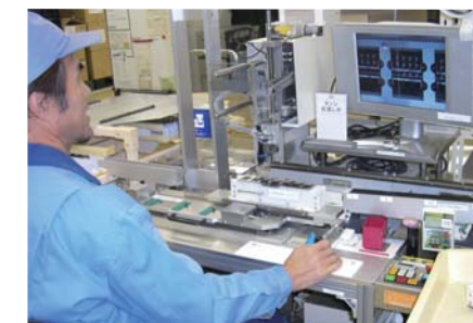
モニターを見ながら小さな穴に部品を入れる作業
