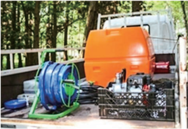
写真2 移動式簡易散水
