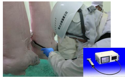
図2 食肉脂質測定装置による豚枝肉のオレイン酸値の測定
