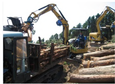
ウインチ付クランプ、フォワーダによる積込の様子
