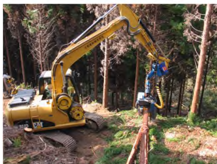
ハーベスタによる伐木造材の様子
