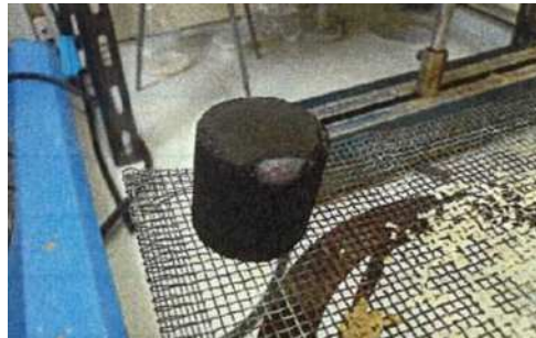
試作竹炭（成形体）の燃焼実験
