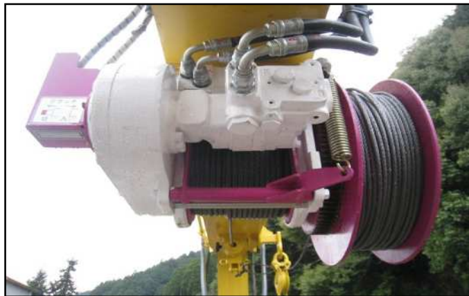
機械改良（ドラム取付け）部分
