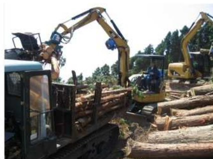
ウインチ付グラップル、フォワーダによる積込の様子
