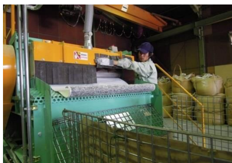
図表 32 破碎機での破碎の様子
