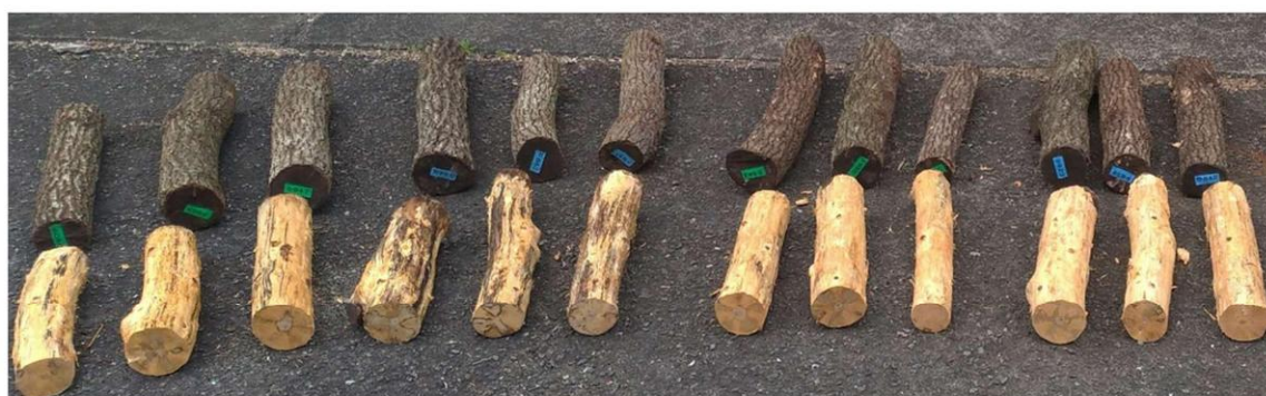
写真-2 R 4 年度試験蔓延状況調査結果 (左 6 本 : 対照区 右 6 本 : 棒積区)
