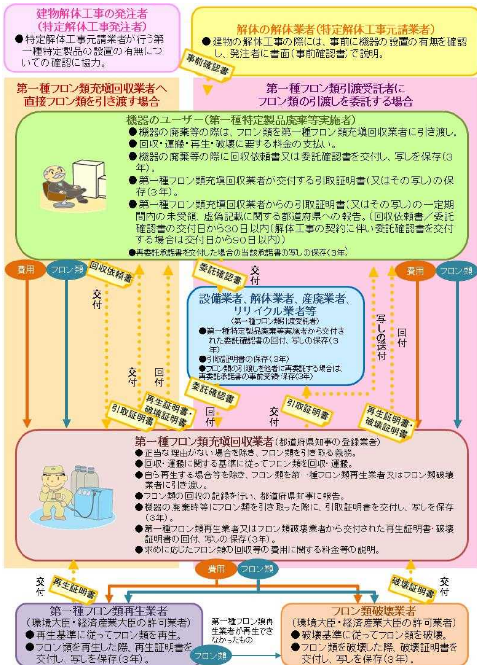
図 10 機器廃棄時等におけるフロン類の引渡しの流れ
