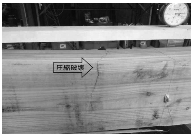
写真-4 圧縮破壊の状況 (南2)
