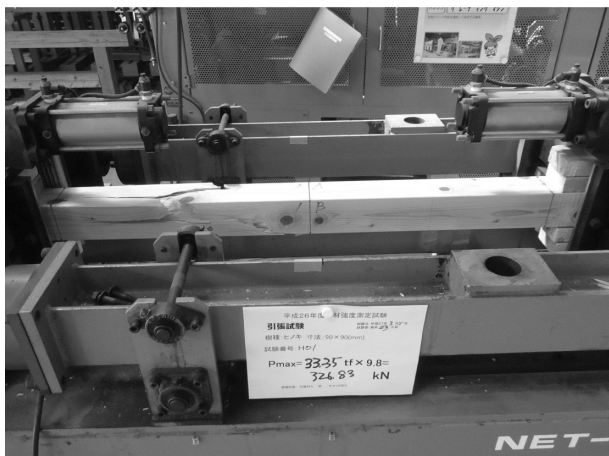
写真-2 縦引張り試験
