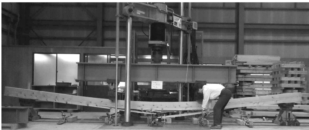
写真-3 曲げ試験の状況 (西1)
