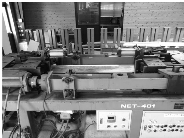
写真-2 引張り試験の様子
