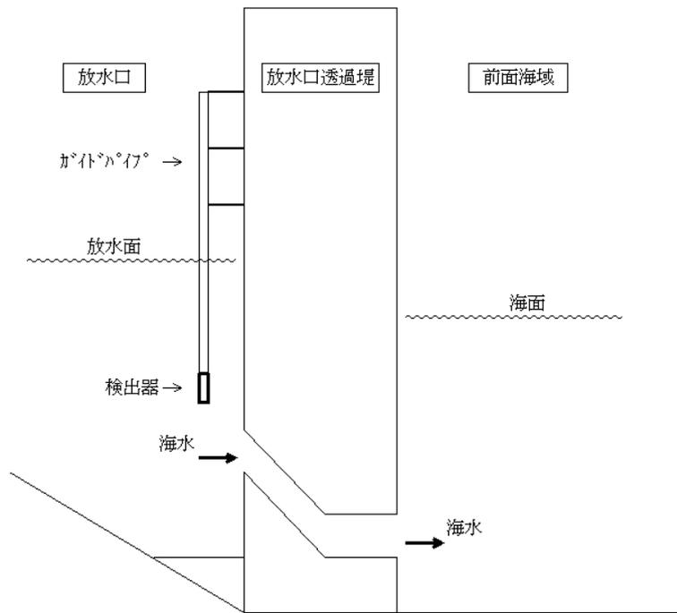
1, 2号機放水口水モニタ設置図
