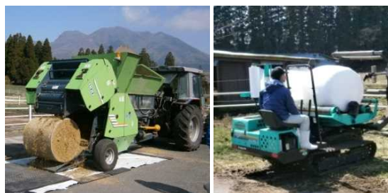
図1 細断型ロールベアラでのTMR調製
