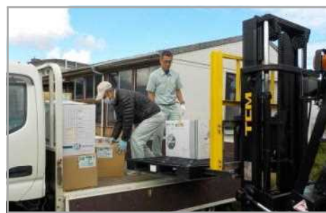
写真5 荷台上で人力で積み重ねれば より多くの資材が積載可能
